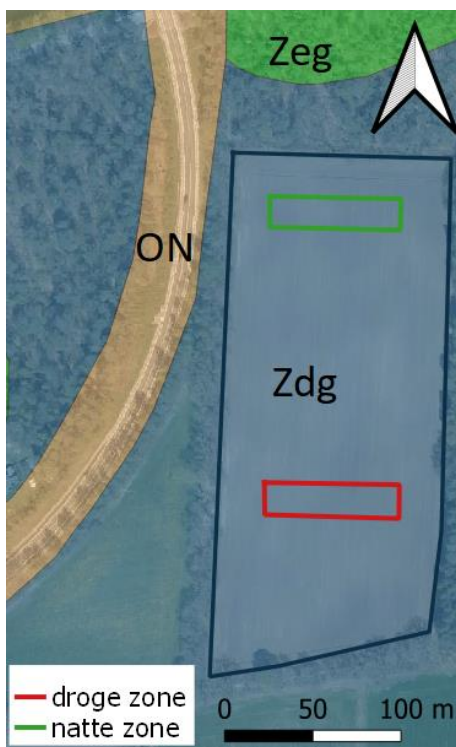
Figuur 5: Bodemkaart voor het onderzochte perceel. Bodemtype Zdg komt voor op gans het perceel. Ten noorden van het perceel komt een natter bodemtype voor (Zeg) wat een indicatie kan zijn dat de bodem vochtiger is meer noordwaarts in het perceel.
