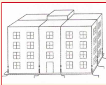
Figuur 45: Bescherming tegen blikseminslag (links) kan bekomen worden door een maaskooi (midden) of een overspanningbeveiliging (rechts)
