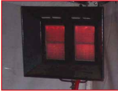
Figuur 25: Zowel een gasstraler (links) als een warme luchtblazer zijn brandgevaarlijk
