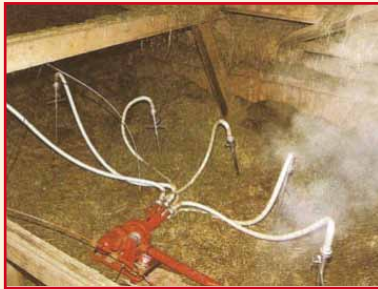
Figuur 37: Zelfontbranding van hooi kan vermeden worden door controle van de temperatuur (links) of door detectie van broeigassen met een smeuldetector (rechts)
